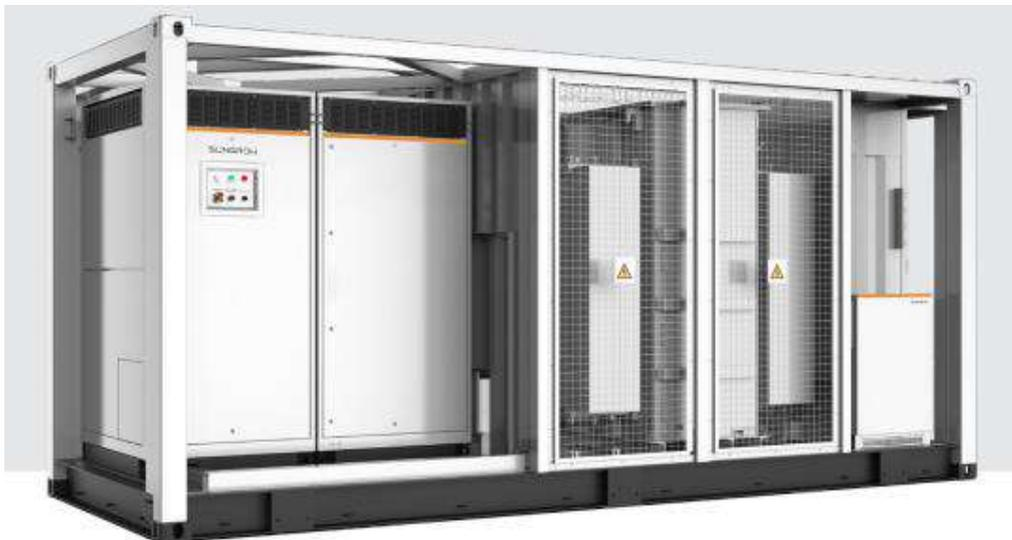
Se compone de 2 convertidores DC-AC/AC-DC con una potencia de salida CA combinada de 4,962 MW, con sus correspondientes protecciones y, transformador de potencia de 0,9/24 kV de 5000 kVA, y 3 celdas MT en disposición 2L+1P, según el diagrama a continuación:
